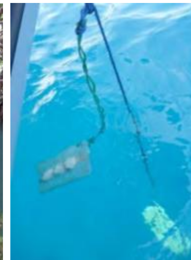
Echantillonneurs passifs en cours d'installation
